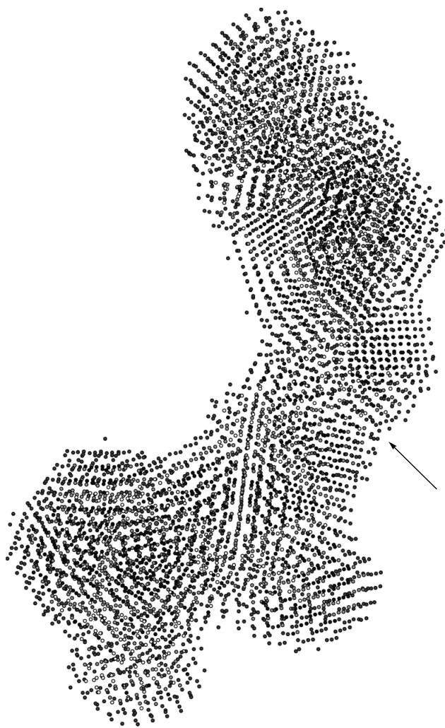
Рис. 6. Изображение кластера Ni_{5909} , полученного при моделировании процесса синтеза из газовой фазы
